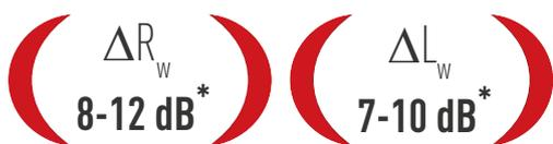
\* Incremento del potere fonoisolante della struttura dopo l'intervento di risanamento
