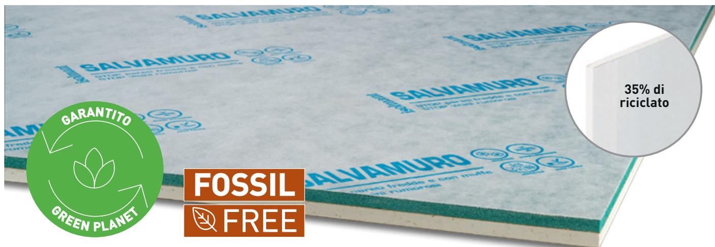
IsolGypsum Special Super Green è una soluzione specifica per il risanamento acustico e termico delle pareti a basso spessore, realizzata con un pannello di Isolmant Special Serie R Fossil Free con spessore 10 mm, rivestito da una specifica teletta in tessuto, accoppiato a una lastra con una percentuale di riciclato del 35% (la lastra con la più alta percentuale di riciclato presente sul mercato).
